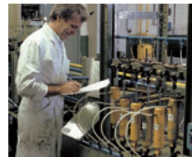
研究施設内では厳しいテストをクリアすることによって、耐久性と信頼性に優れたショックアブソーバを生み出している。スラロームやブレーキテストなど実車を使ったテストも実施され、安全かつ快適な乗り味を実現するためのデータを取集。100年という長い歴史の中で培ったノウハウは、現在のショックアブソーバにも受け継がれている。
