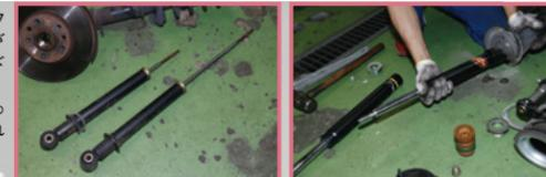
ショックアブソーバの交換を前提に、カートリッジ式の構造を採用している車種も多数存在。
